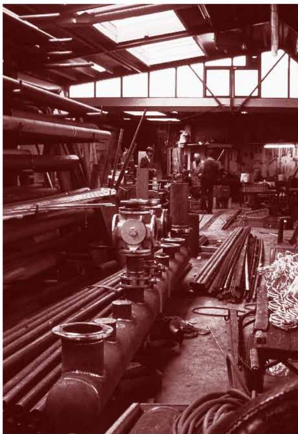
Verdeelstukken voor tuinbouwinstallaties werden in de werkplaats opgebouwd.
